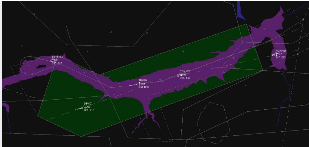
Abbildung 3 – MLAT Display. Dargestellt: CTR LOWI, LOC „OEV“ und „OEJ“ Centerlines, RNP Tracks. In violett: 3000ft MSL-Schichtlinie. In blau: Achensee, Inn
