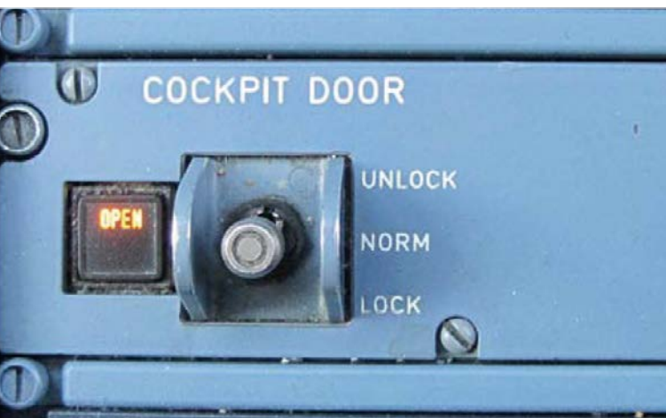
Bild 5 – Kippschalter der Cockpittür
